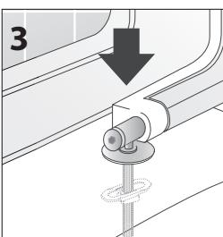
**3** Innestare le cerniere già montate sul coprivaso sui due piantoni installati sul sanitario.
