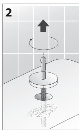
**2** Avitare i piantoni tenendoli sollevati in modo che il bloccaggio "Orizon" sia in battuta con la ceramica. Stringere senza bloccare completamente, il piantone si deve poter muovere sul piano del sanitario.
