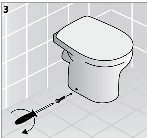
**3**\_Bloccare il vaso con le apposite viti di fissaggio facenti parte del kit ed applicare sopra le due borchiette di copertura cromate.
