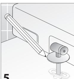
**5** Con il sedile ben fermo e centrato segnare con una matita la parte posteriore delle due rondelle cromate in modo da avere un riferimento per il bloccaggio definitivo.
