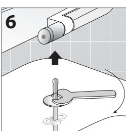
**6** Sfilare il sedile e bloccare definitivamente i piantoni con l'apposita chiave fornita nel kit mantenendo la rondella cromata allineata al segno tracciato precedentemente a matita. Per un corretto bloccaggio dei 2 piantoni effettuare 2 giri completi con la chiave.
