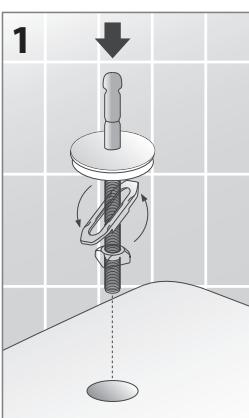
**1** Inserire i due piantoni nei fori di fissaggio sul sanitario allineando i due blocchaggi "Orizon" alla vite filettata in modo da poter passare all'interno del foro.
