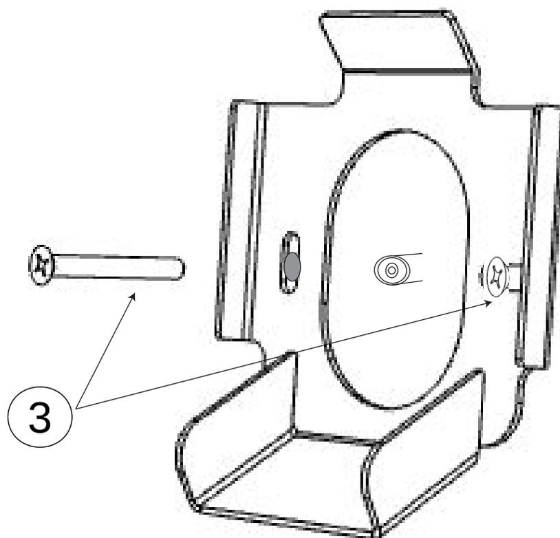
**IT** - Riprendete la staffa di fissaggio (1) di pag.3 e posizionate in modo che le asole della staffa stessa coincidano con i tasselli precedentemente inseriti nei fori della parte ed avvitate i bulloni (Fig.3) fino al completo serraggio. Ora potete collegare il tubo fornito prima al soffione e dopo alla rete idrica trattene-
