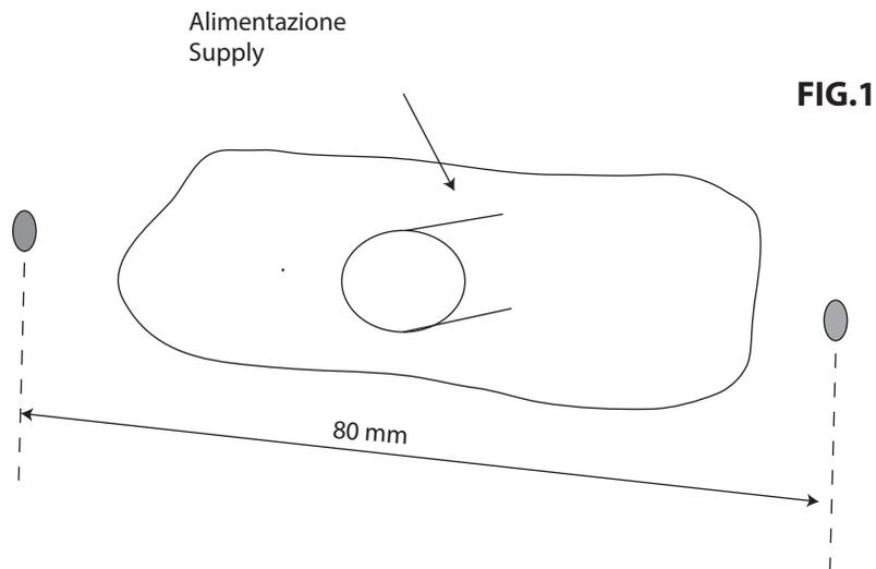
**IT** - A questo punto si può provvedere alla foratura della parete (Fig.1) utilizzando una punta da  $\varnothing 10$  ed in seguito all'inserimento dei due tasselli (forniti).
