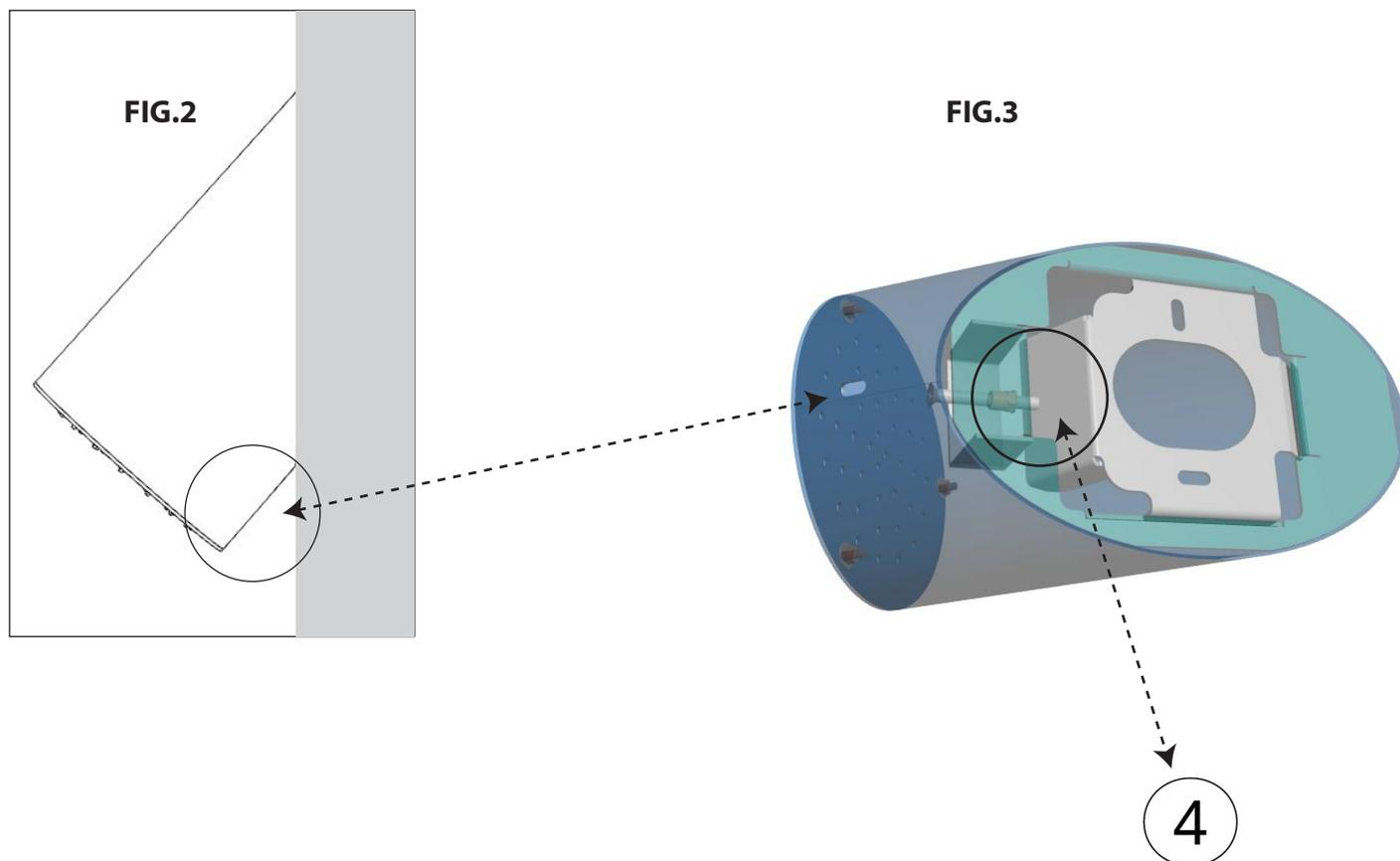
**IT** - Ora appoggiate il vostro nuovo soffione alla parete (fig.2) centrandolo sulla staffa appena fissata facendo attenzione a non piegare il tubo di alimentazione. sempre in fig.2 viene evidenziata la zona riportata in fig.3: in questa asola posizionata sotto al soffione troverete preassemblato il grano che, avvitandolo con una chiave a brugola da mm 3 (non fornita), comprimerà il soffione alla parete lavorando sulla parte obliqua della staffa(4) già fissata alla parete precedentemente.
